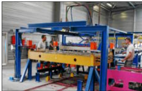
● Le nouvel atelier (1.250 m 2 ) est conçu pour produire, chaque jour, quelque 1.200 traverses de chemin de fer en béton précontraint.
